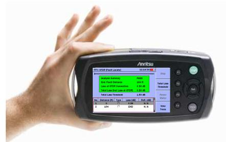
Il dispose des fonctionnalités d'un réflectomètre optique aux longueurs d'ondes choisies 780nm et 1550nm. Il intègre en option un Wattmètre, un microscope et une source visible.
