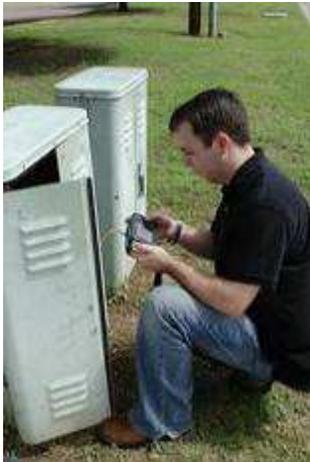
Le Network Master est l'outil terrain de base indispensable pour l'installateur de réseaux optiques, au même titre que le multimètre pour l'installateur de réseaux électriques.
