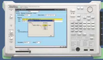
Le MP1590B, équipement modulaire, est le seul capable de vous fournir dans un même châssis portable les interfaces de mesures pour l'OTN OTU1 et 2, SDH SONET STM1 à 64, EoS STM 16, le PDH et DSn, ainsi que les tests de Gigue. Ce châssis supporte la plupart des cartes du MD1230B ainsi que ses fonctionnalités.
