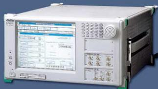
Le MP1632A fait partie de la famille des BERT, il répond aux besoins des tests sur les composants ou équipements dans les réseaux Ethernet ou SDH jusqu'au STM-16/OC-48 (2.488 Gbit/s).
