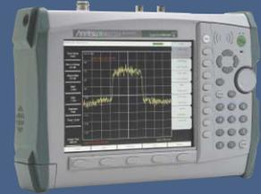
L'analyseur de spectre MS2721A permet d'effectuer maintenant sur le terrain des mesures qui n'étaient autrefois possible qu'avec un appareil de laboratoire.
