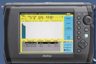
Relié à un récepteur GPS, le ML8720B permet d'évaluer le champs reçu en provenance de plusieurs stations de base W-CDMA et d'en effectuer une corrélation géographique. Il autorise également les mesures de retards relatifs aux propagations multitrajets du CPICH, P-SCH et S-SCH grâce à son récepteur RAKE, conformément à la norme 3GPP TS 25.215.
