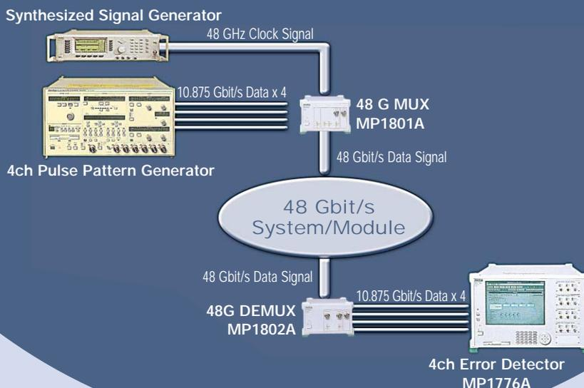
La série ME77x0A évalue les transmissions à hauts débits pour des systèmes et modules de 25 Mb/s à 48 Gb/s. Elle est composée d'instruments indépendants pouvant être vendus séparément :
