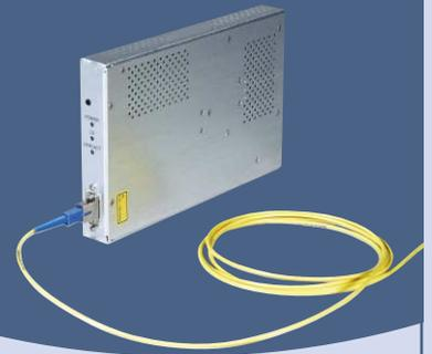
Ce réflectomètre optique est un module miniaturisé de taille inférieure au format A5. Il se place dans des systèmes ou bancs de mesure, pour effectuer des tests sur les connexions optiques. Le MW9077 est piloté par un port Ethernet ou RS232, ce qui permet de prendre le contrôle de l'OTDR en proche ou distant, pour la configuration ou pour obtenir les résultats de mesure.
