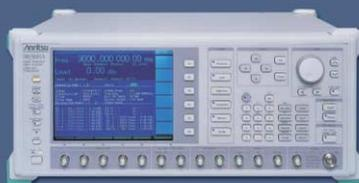
Le MG3681A est un générateur de modulations numériques hautes performances conçu pour les signaux W-CDMA. Couvrant des débits de 1,6 Mchip/s à 16,5 Mchip/s et une bande de modulation I/Q de 30 MHz, il est l'outil idéal pour l'analyse des composants et des stations de base de la prochaine génération UMTS.
