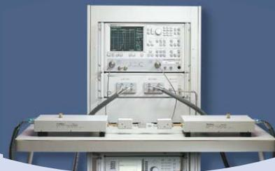
Construit autour de l'analyseur de réseaux vectoriels 65 GHz (37397D), le ME7808B couvre la bande 40 MHz à 110 GHz en un seul balayage rapide avec une dynamique > 70 dB sous pointe à 100 GHz. Il est spécialement conçu pour la modélisation et la simulation des circuits large bande.
