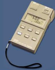
Le MS9020D est un appareil modulaire destiné principalement aux applications terrain sur les fibres optiques monomodes et multimodes. Il accepte différents modules source et détecteur.
