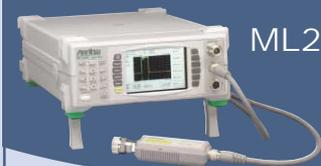
Ces milliwattmètres permettent d'effectuer des mesures dans la gamme 100 KHz à 65 GHz selon le type de sonde vecteur.
