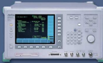
Le Testeur de Mobile MT8820A permet d'effectuer aussi bien le Test Radio que le Test protocole de mobiles W-CDMA, en conformité avec la norme 3GPP TS34.121. Sa capacité de mesure de l'ensemble des tests Radio en 200 millisecondes est particulièrement adaptée aux besoins de production de masse des mobiles de 3<sup>ème</sup> génération. Il permet également de tester les mobiles GSM / GPRS et le Handover W-CDMA / GSM / GPRS / EDGE...
