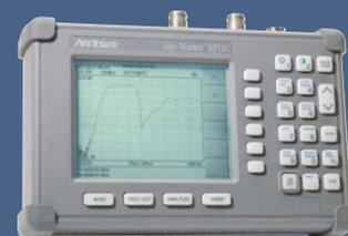
Le Site Master modèle S251C, membre de la famille des Site Master est tout particulièrement optimisé pour le test des câbles, antennes et MHA / LNA utilisés en GSM, DCS 1800 et UMTS.
