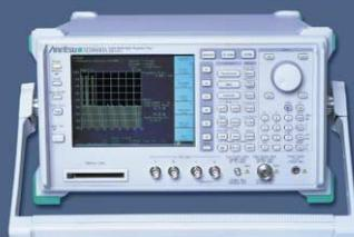
Le MS8608/09A incorpore un testeur de transmission numérique, un milliwattmètre et un analyseur de spectre (RBW de 20 MHz). Il permet une analyse complète des modulations et notamment la puissance des Code Domain en W-CDMA, la puissance transmise, la puissance dans les canaux adjacents, la bande occupée et les émissions parasites.
