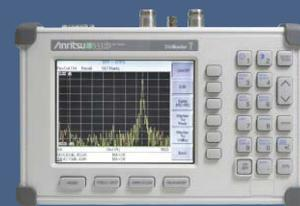
Le Site Master modèle S332D permet d'effectuer toutes les mesures nécessaires lors de l'installation puis de la maintenance des systèmes de câbles et d'antennes dans la bande de 2 MHz à 4 GHz, notamment : R.O.S, pertes d'insertion, localisation de défaut de câbles coaxiaux, découplage d'antennes et gain de LNA. Le S332D incorpore un analyseur de spectre haute performance et autorise des mesures 2 ports en transmission avec une dynamique > 90 dB.
