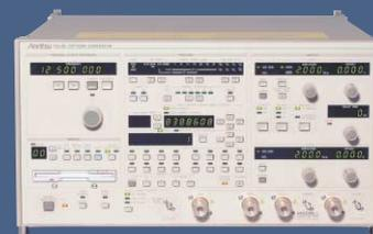
Le générateur MP1763C et le détecteur MP1764C forment un testeur de taux d'erreurs jusqu'à 12,5 Gb/s. Il permet de générer et d'analyser des séquences pseudo aléatoires (2<sup>31</sup>-1 à 2<sup>21</sup>-1) ou programmées (longueurs de 2 bits à 8 Mbits).
