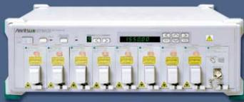
Le MT9812B est une plateforme modulaire pourvue de 9 emplacements permettant différentes combinaisons dans l'utilisation des sources et des puissancemètres optiques. Le MT9812B intègre les mêmes modules que le MT9810B.
